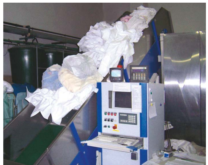
Abb_4: Transportband zur Befüllung der Waschmaschine.
